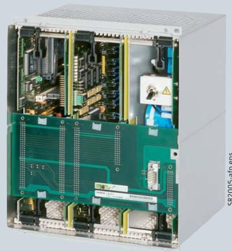
Frontansicht. Im mittleren Steckplatz ist eine DAU-Baugruppe sichtbar
